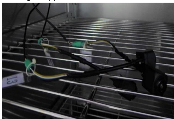
图 95 样品带电高湿保存图片 Fig 95 samples in high-humidity chamber
