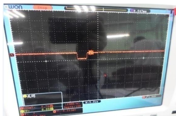
图 314 黑电平输出图片 Fig314 output of dark level
