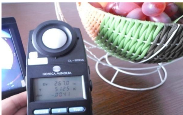
图 144 色温 5100K 彩色重现测试图片 Fig 144 color reproduction at color temperature 5100K
