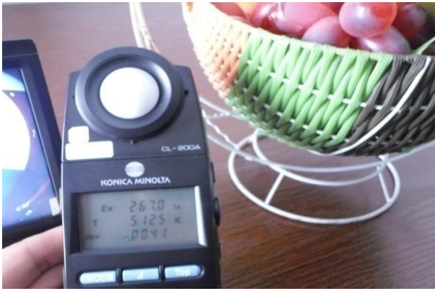
图 301 色温 5100K 彩色重现测试图片 Fig301 color reproduction at color temperature 5100K
