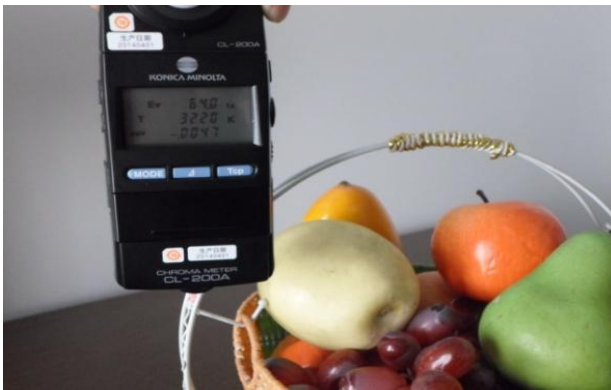
图 365 色温 3200K 测试图片 Fig365 color reproduction at color temperature 3200K
