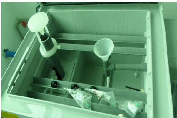
图 134 盐水喷雾测试图片 Fig 134 salt water spray test
