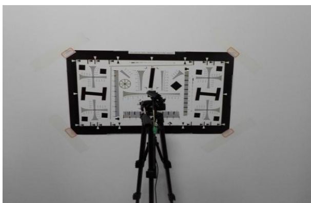
图 213 分辨率测试图片 Fig 213 resolution test
