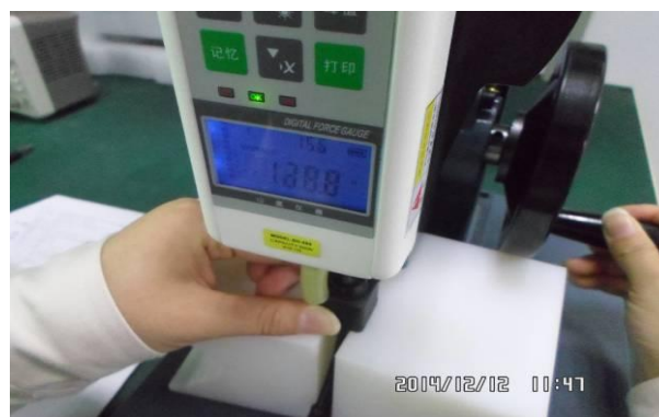
图 196 压力作用在样品左下角 Fig 196 strain applied on the lower left corner
