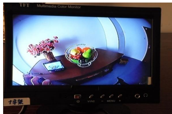
图 52 色温 3200K 输出图片 Fig 52 output of color reproduction
