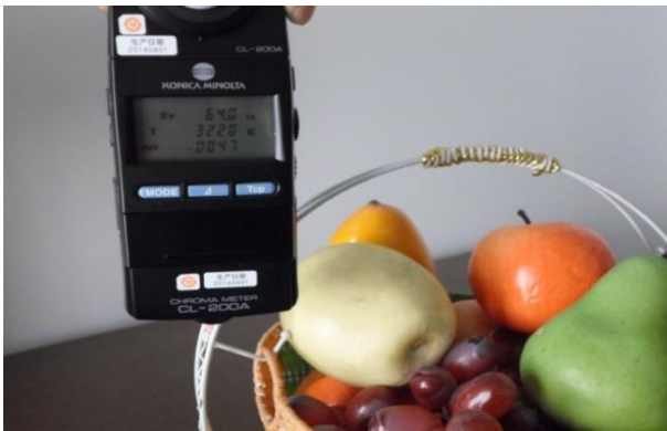
图 184 色温 3200K 测试图片 Fig 184 color reproduction at color temperature 3200K
