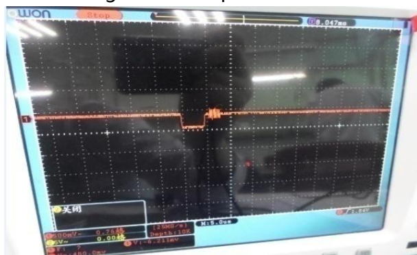
图 158 黑电平输出图片 Fig158 output of dark level
