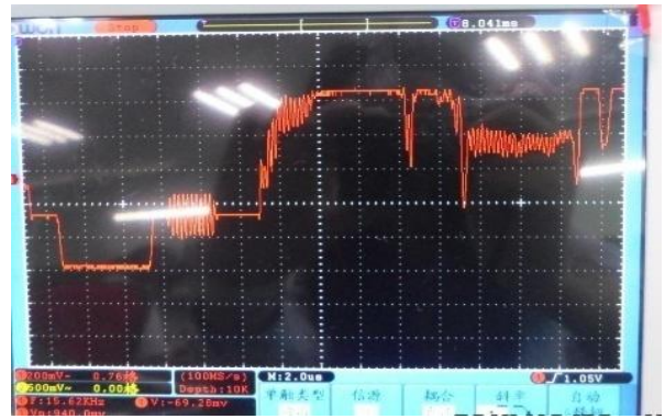
图 356 图像电平输出图片 Fig356 output of image signal level
