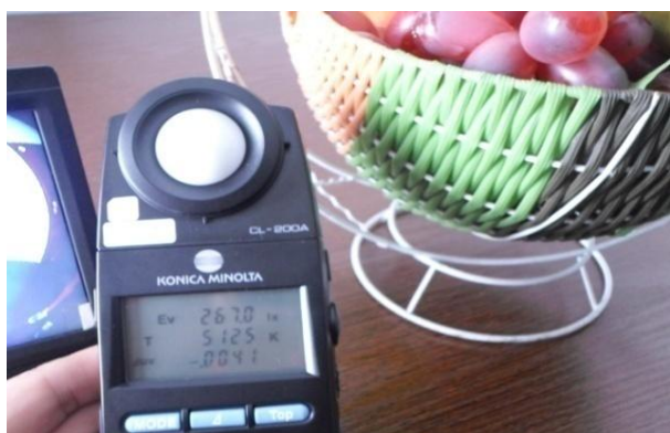
图 123 色温 5100K 彩色重现测试图片 Fig123 color reproduction at color temperature 5100K
