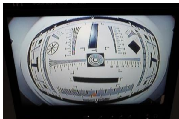
图 316 分辨率输出图片 Fig316 output of resolution
