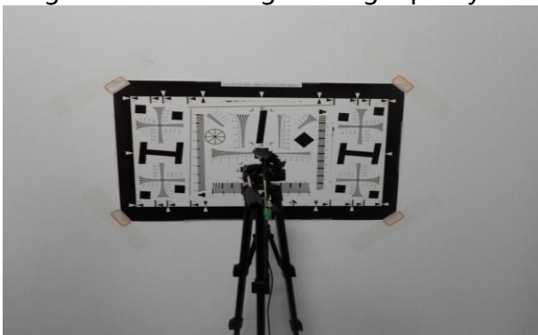
图 299 分辨率测试图片 Fig299 resolution test
