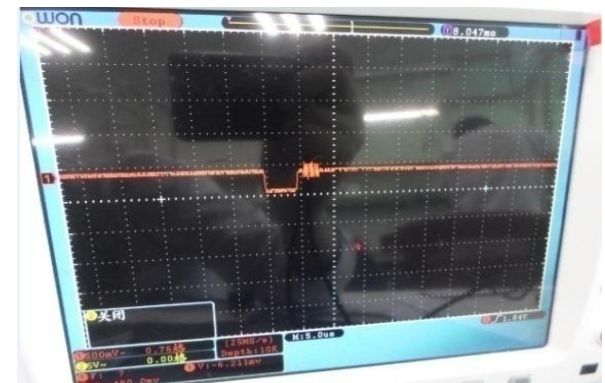
图 298 黑电平输出图片 Fig298 output of dark level
