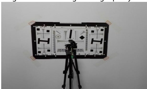
图 159 分辨率测试图片 Fig 159 resolution test
