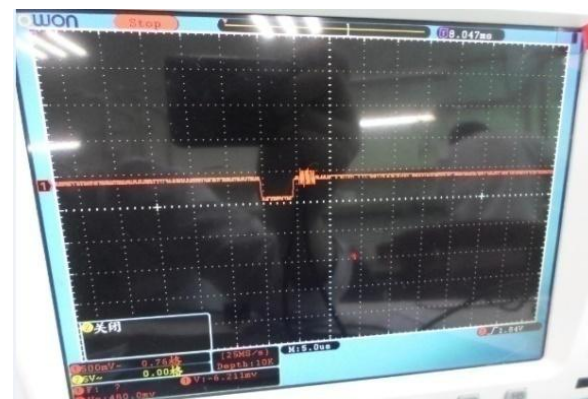
图 212 黑电平输出图片 Fig212 output of dark level
