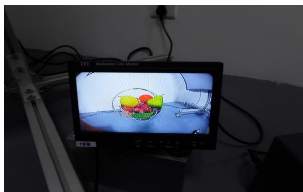
图 145 色温 5100K 测试输出图片 Fig 145 output of color reproduction
