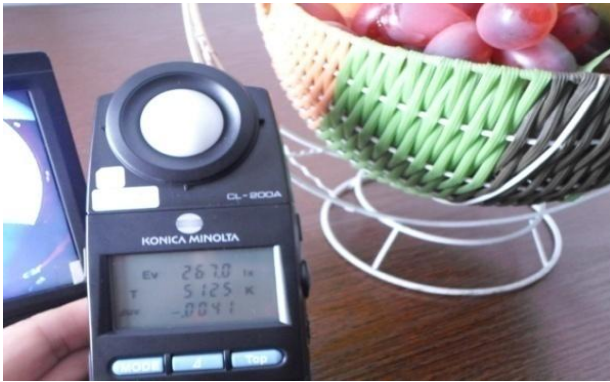
图 249 色温 5100K 彩色重现测试图片 Fig101 color reproduction at color temperature 5100K
