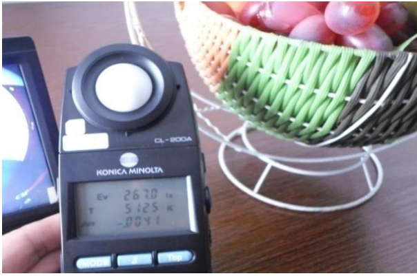
图 49 色温 5100K 彩色重现测试图片 Fig 49 color reproduction at color temperature 5100K
