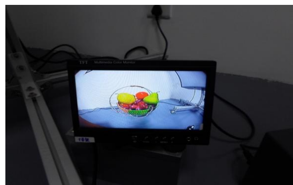
图 318 色温 5100K 测试输出图片 Fig318 output of color reproduction CDD-R-466(2.0)
