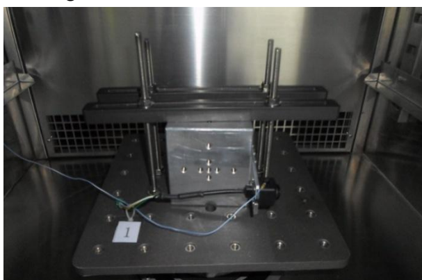
图 343 横向查找共振点 Fig343 lateral direction dectect
