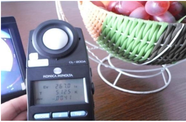
图 215 色温 5100K 彩色重现测试图片 Fig 215 color reproduction at color temperature 5100K
