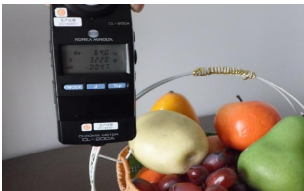
图 271 色温 3200K 测试图片 Fig271 color reproduction at color temperature 3200K
