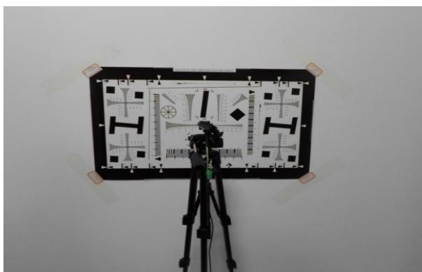
图 333 分辨率测试图片 Fig333 resolution test
