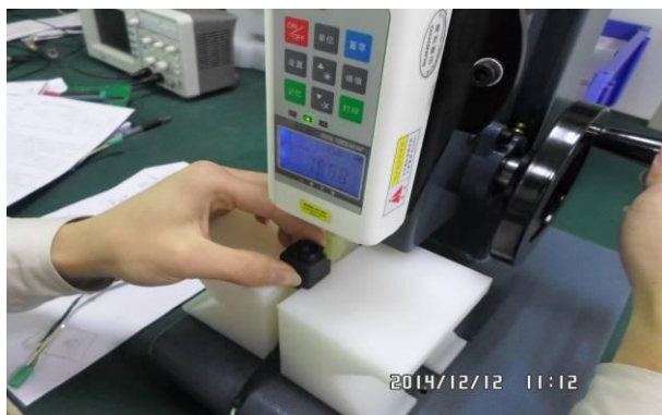
图 195 压力作用在样品右上角 Fig 195 strain applied on the upper right corner
