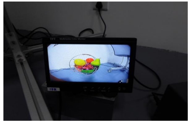
图 286 色温 5100K 测试输出图片 Fig286 output of color reproduction
