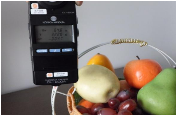
图 33 色温 3200K 测试图片 Fig 33 color reproduction at color temperature 3200K
