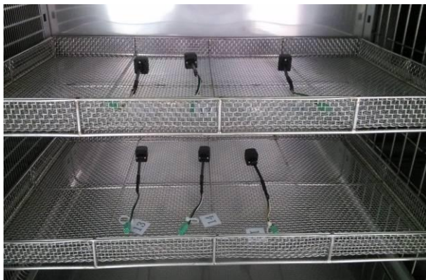
图 73 冷热冲击试验图片 Fig 73 Thermal shock test
