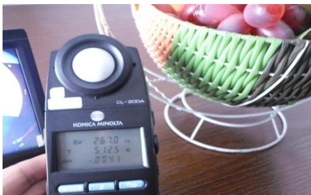
图 233 色温 5100K 彩色重现测试图片 Fig 233 color reproduction at color temperature 5100K
