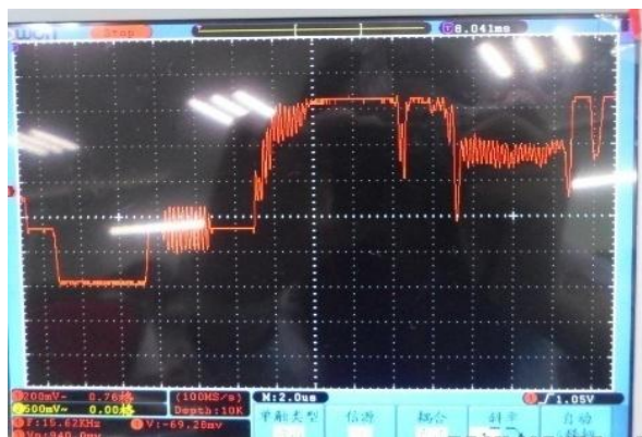
图 242 图像电平输出图片 Fig242 output of image signal level
