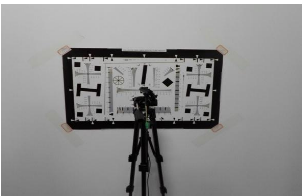
图 180 分辨率测试图片 Fig180 resolution test
