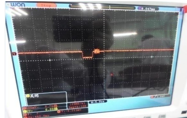
图 141 黑电平输出图片 Fig 141 output of dark level
