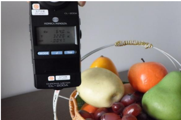
图 217 色温 3200K 测试图片 Fig 217 color reproduction at color temperature 3200K
