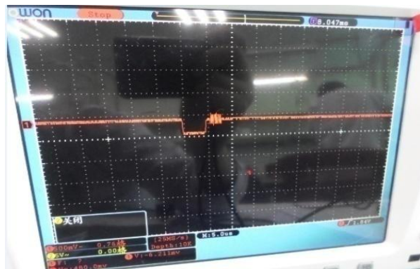
图 230 黑电平输出图片 Fig 230 output of dark level
