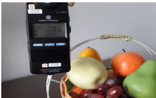
图 337 色温 3200K 测试图片 Fig337 color reproduction at color temperature 3200K 保存期限(Save Time): 报告发行日起 3 年(3 years)
