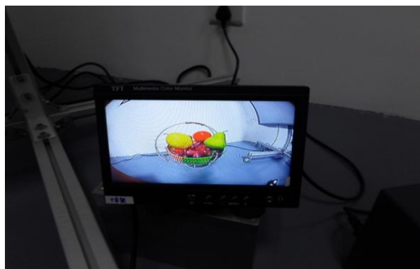
图 234 色温 5100K 测试输出图片 Fig 234 output of color reproduction
