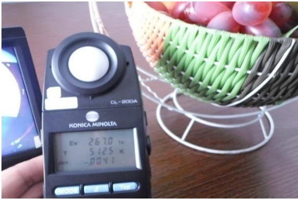
图 67 色温 5100K 彩色重现测试图片 Fig67 color reproduction at color temperature 5100K
