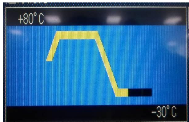
图 74 冷热冲击试验曲线 Fig 74 Temperature curve
