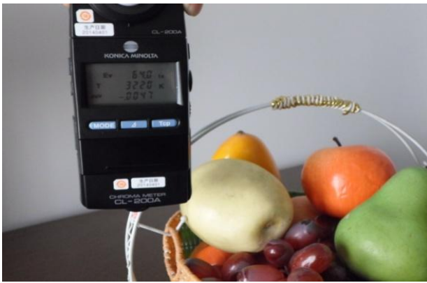
图 303 色温 3200K 测试图片 Fig303 color reproduction at color temperature 3200K
