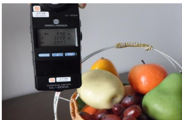
图 125 色温 3200K 测试图片 Fig125 color reproduction at color temperature 3200K
