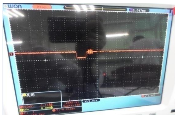
图 332 黑电平输出图片 Fig332 output of dark level
