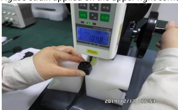
图 197 压力作用在样品右下角 Fig 197 strain applied on the lower right corner
