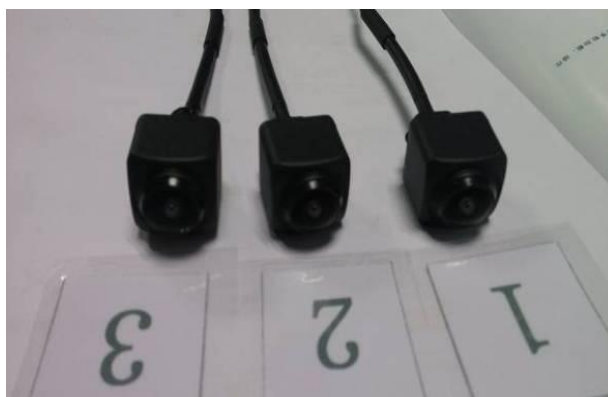
图 57 低温操作试验前样品外观图片 Fig57 appearance before test
