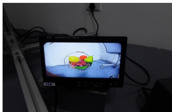
图 124 色温 5100K 测试输出图片 Fig124 output of color reproduction
