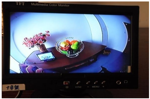
图 70 色温 3200K 输出图片 Fig70 output of color reproduction
