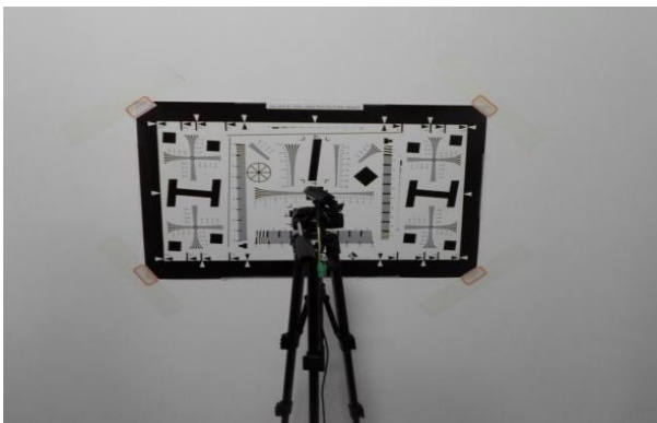
图 142 分辨率测试图片 Fig 142 resolution test
