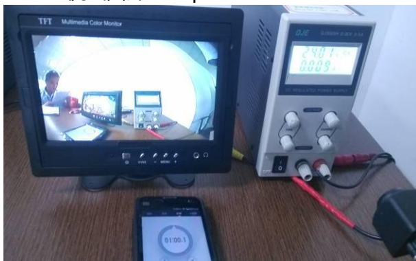
图 323 过电压测试图片 Fig323 overvoltage test
