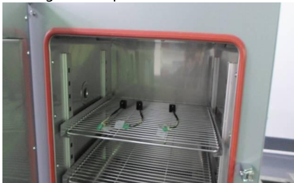
图 223 样品高温保存图片 Fig223 samples maintain in high temperature
