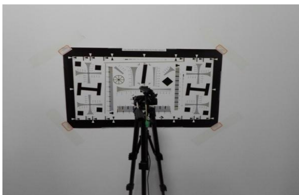
图 315 分辨率测试图片 Fig315 resolution test
