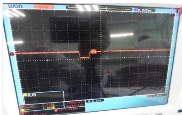
图 266 黑电平输出图片 Fig 266 output of dark level
