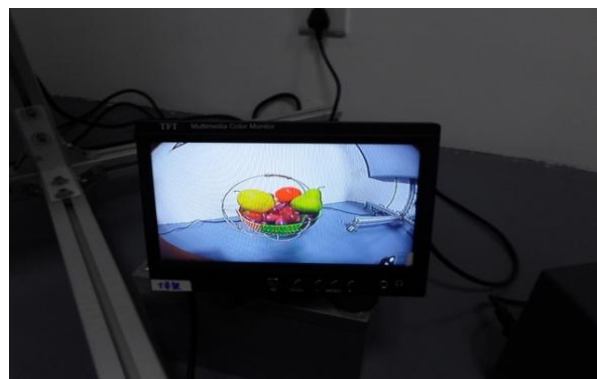
图 270 色温 5100K 测试输出图片 Fig270 output of color reproduction
