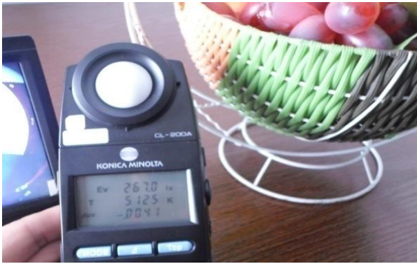
图 104 色温 5100K 彩色重现测试图片 Fig 104 color reproduction at color temperature 5100K
