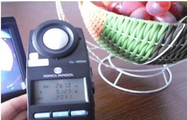
图 285 色温 5100K 彩色重现测试图片 Fig285 color reproduction at color temperature 5100K
