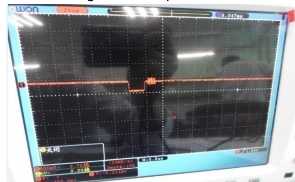
图 282 黑电平输出图片 Fig282 output of dark level
