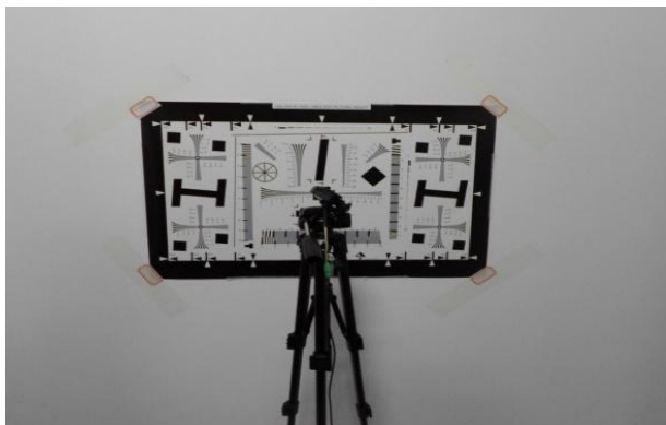
图 231 分辨率测试图片 Fig 231 resolution test
