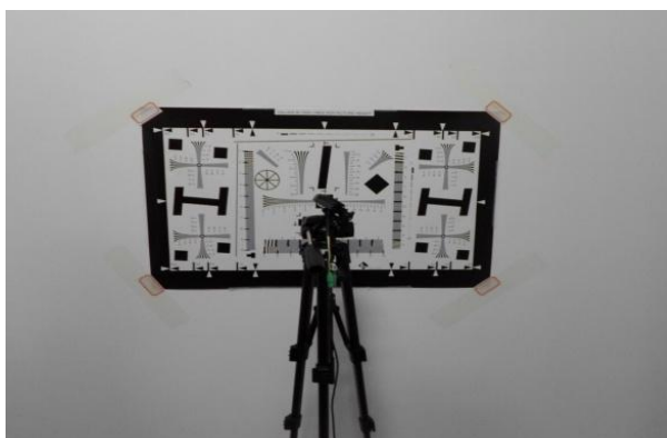
图 47 分辨率测试图片 Fig 47 resolution test
