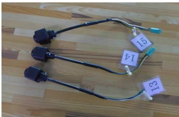
图 92 防止结露测试前样品外观图片 Fig92 appearance before test
