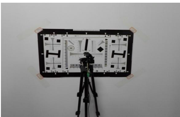
图 29 分辨率测试图片 Fig 29 resolution test
