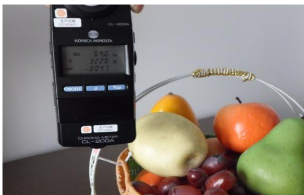
图 146 色温 3200K 测试图片 Fig 146 color reproduction at color temperature 3200K
