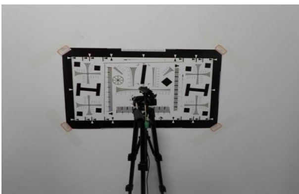
图 102 分辨率测试图片 Fig 102 resolution test
