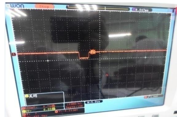
图 246 黑电平输出图片 Fig 246 output of dark level
