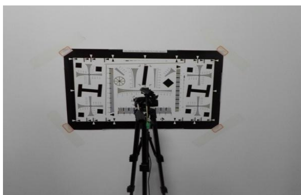
图 11 分辨率测试图片 Fig 11 resolution test
