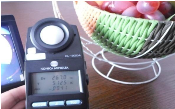
图 363 色温 5100K 彩色重现测试图片 Fig363 color reproduction at color temperature 5100K
