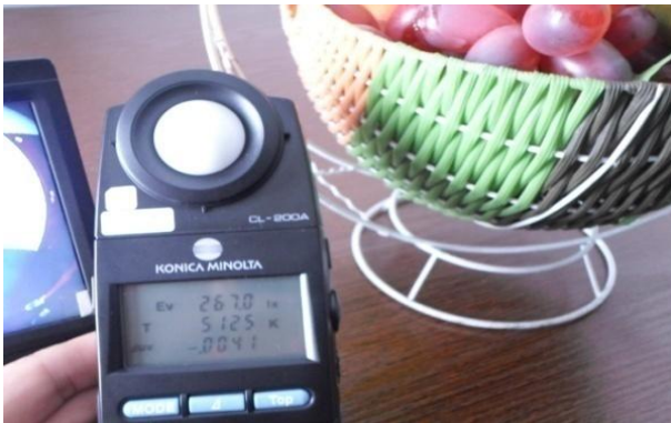
图 85 色温 5100K 彩色重现测试图片 Fig 85 color reproduction at color temperature 5100K
