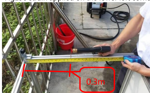
图 198 防水试验 Fig 198 water resistance test
