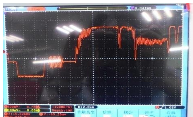
图 154 图像电平输出图片 Fig154 output of image signal level
