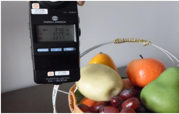
图 163 色温 3200K 测试图片 Fig163 color reproduction at color temperature 3200K
