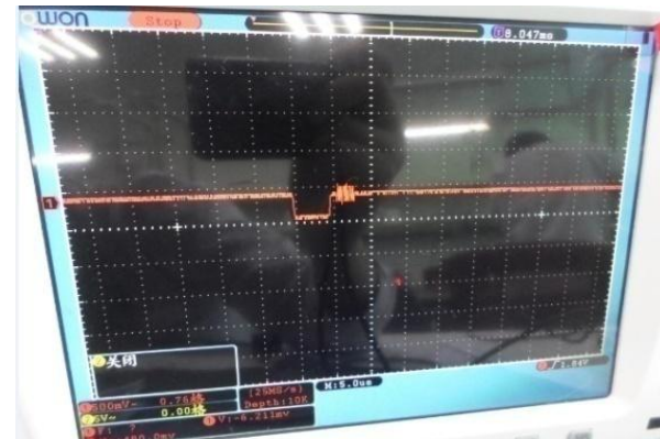
图 46 黑电平输出图片 Fig 46 output of dark level
