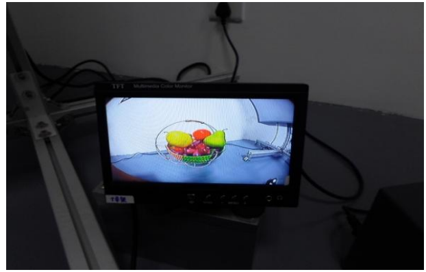
图 183 色温 5100K 测试输出图片 Fig 183 output of color reproduction
