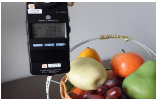
图 235 色温 3200K 测试图片 Fig 235 color reproduction at color temperature 3200K 保存期限(Save Time): 报告发行日起 3 年(3 years)
