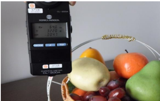
图 251 色温 3200K 测试图片 Fig251 color reproduction at color temperature 3200K
