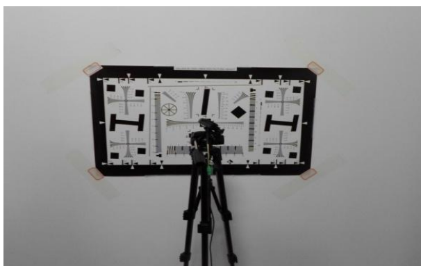
图 247 分辨率测试图片 Fig 247 resolution test
