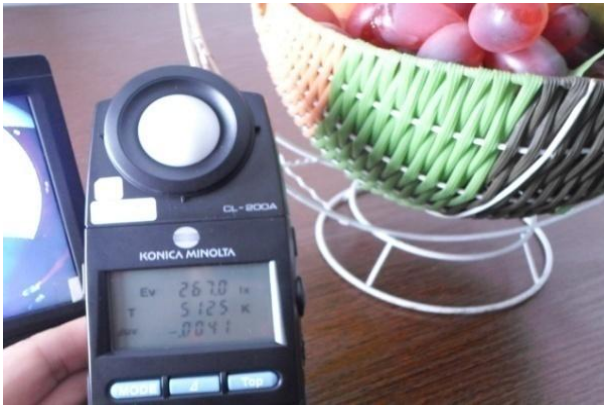
图 31 色温 5100K 彩色重现测试图片 Fig 31 color reproduction at color temperature 5100K
