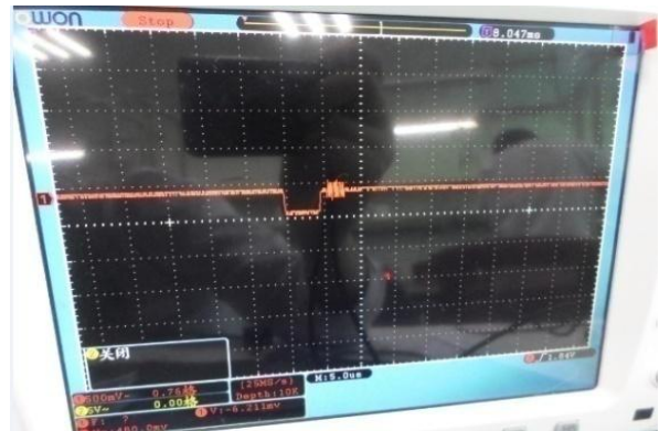
图 101 黑电平输出图片 Fig 101 output of dark level
