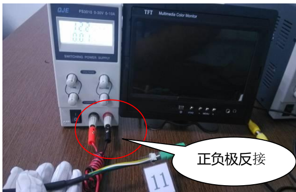
图 289 反极性测试图片 Fig289 reversed polarity test
