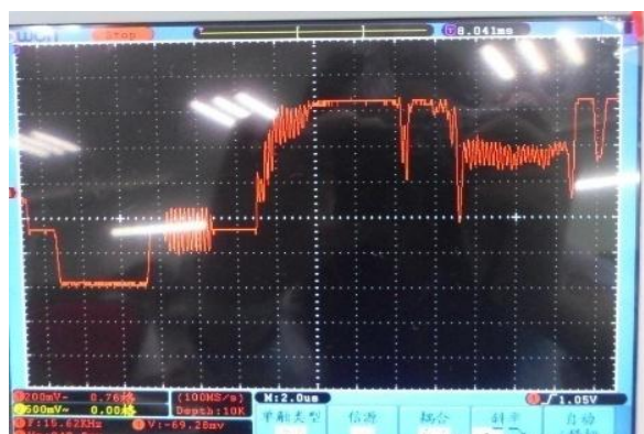
图 6 图像电平输出图片 Fig 6 output of image signal level
