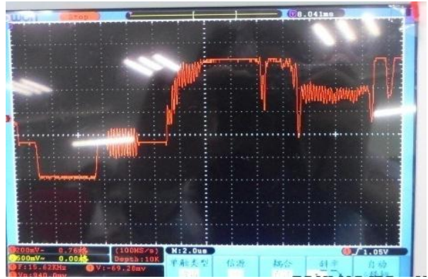
图 24 图像电平输出图片 Fig 24 output of image signal level
